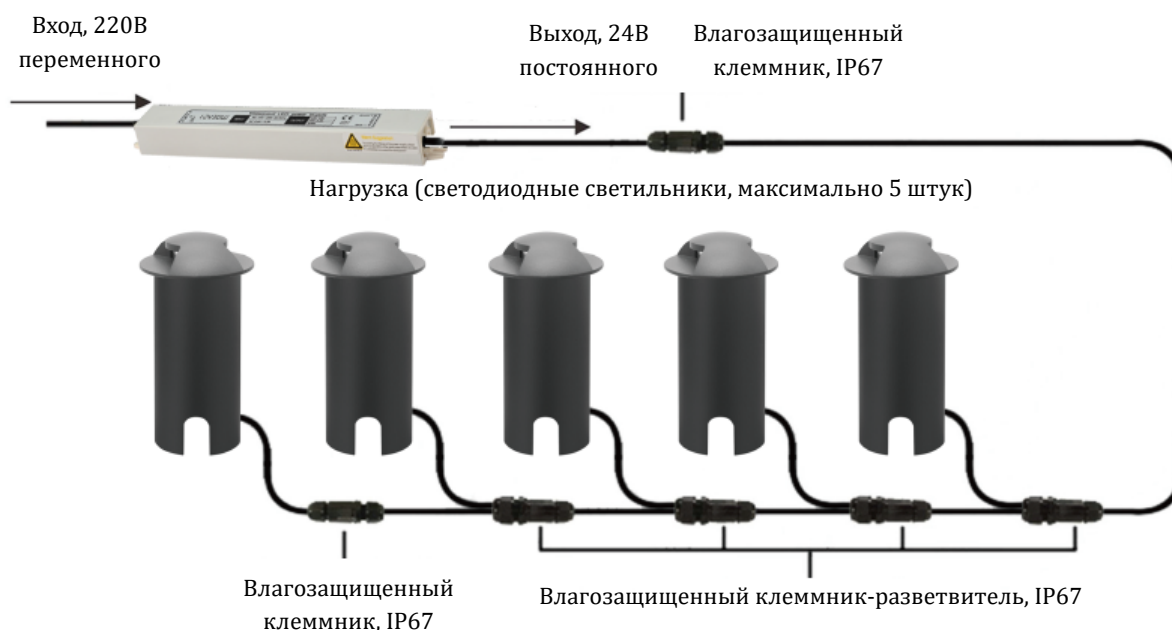
Рисунок 3 – Общая схема подключения нагрузки (светильников) к источнику питания и включение его в сеть
